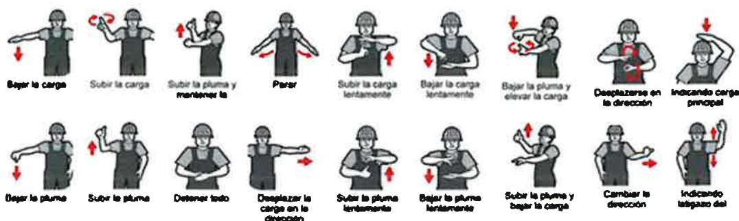
Señalización maniobras izaje – Grúa/Rigger
