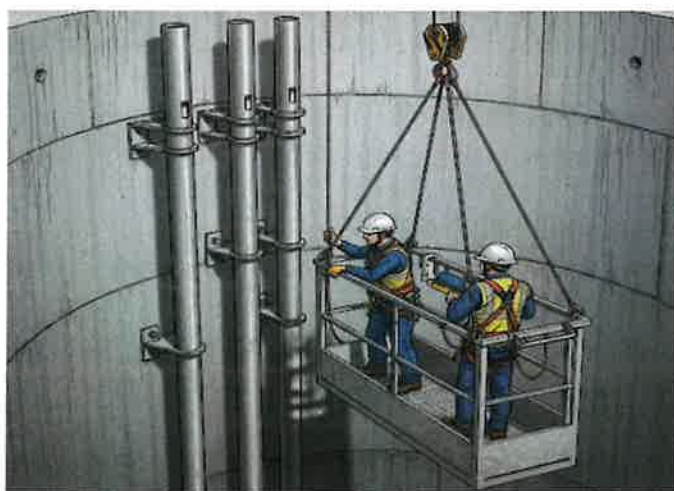
Esquema de trabajo excepcionales desde cesta suspendida de gancho de grúa
