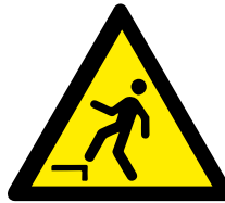
CAÍDA A DISTINTO NIVEL
