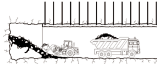
Carga, saneo y desescombro
