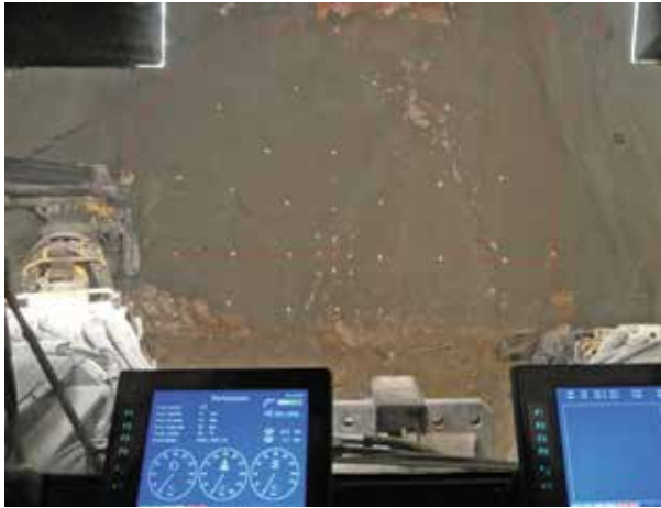
Panel con plan de otro para barrenos.
